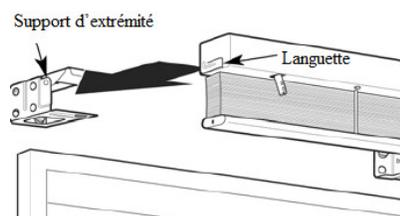
Abaissez la partie avant de chaque support d'extrémité et appuyez jusqu'à ce que la languette s'enclenche bien en place.
