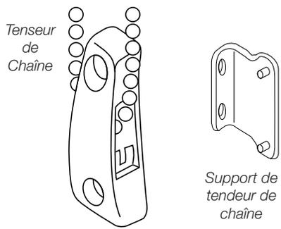
à billes de l'autre main. Soulevez la chaîne à billes hors de la rainure de verrouillage des billes et faites glisser le dispositif de tension jusqu'au bas de la boucle de la chaîne.
