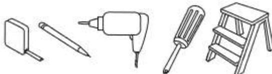
*Note : Utilisez une mèche de 5/64 po pour percer les trous destinés aux vis (pour une installation dans un poteau (stud) mural ou une solive). Utilisez une mèche de 1/4 po pour les chevilles en plastique (pour une installation dans une cloison sèche ou dans du plâtre).*
