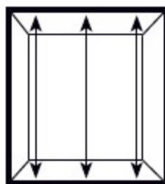
À l'aide de votre ruban en acier, mesurez à l'extérieur de l'ouverture à partir de la partie supérieure jusqu'à l'obstacle qui s'avance le plus sur la partie inférieure de la fenêtre. Prenez ces mesures à gauche, au milieu et à droite de la fenêtre. Conservez la plus longue de ces mesures comme étant la mesure de référence. Cette mesure déterminera la hauteur de votre fenêtre.
