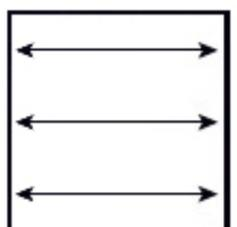
À l'aide de votre ruban en acier, mesurez à l'intérieur de l'ouverture à partir du côté gauche jusqu'à l'obstacle qui s'avance le plus du côté droit de la fenêtre. Prenez ces mesures au bas, au milieu et au haut de la fenêtre. Conservez la plus petite de ces mesures comme étant la mesure de référence. Cette mesure déterminera la largeur de votre fenêtre.
