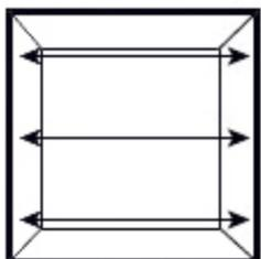
À l'aide de votre ruban en acier, mesurez à l'extérieur de l'ouverture à partir du côté gauche jusqu'à l'obstacle qui s'avance le plus du côté droit de la fenêtre. Prenez ces mesures au bas, au milieu et au haut de la fenêtre. Conservez la plus longue de ces mesures comme étant la mesure de référence. Cette mesure déterminera la largeur de votre fenêtre.
