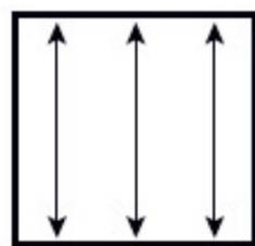
À l'aide de votre ruban en acier, mesurez à l'intérieur de l'ouverture à partir de la partie supérieure jusqu'à l'obstacle qui s'avance le plus sur la partie inférieure de la fenêtre. Prenez ces mesures à gauche, au milieu et à droite de la fenêtre. Conservez la plus petite de ces mesures comme étant la mesure de référence. Cette mesure déterminera la hauteur de votre fenêtre.
